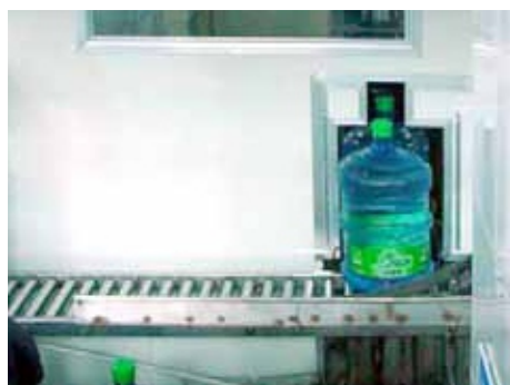
Отвор на конвейера, съобразен с размера на опаковките
