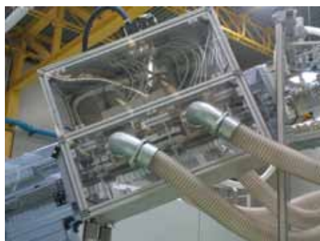
Осигурен поток с филтриран въздух за почистване на преформите, преди постъпването им за издуване
