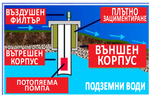
Класическа схема на водоизточник, изграден за водовземане на подземни води
