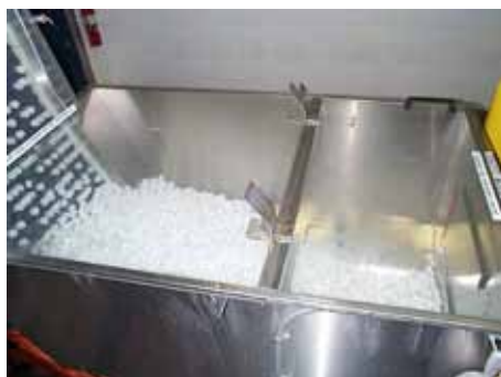
Бункер за подаване на капачки – осигурен с подходящо покритие срещу замърсяване
