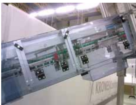
Изградено подходящо покритие на конвейерите, с цел предпазване от замърсяване
