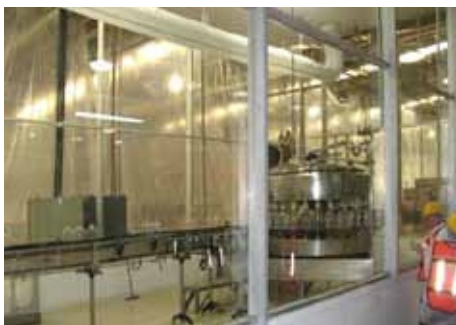
Осигурена подходяща защита на зоната за пълнене по време на ремонт (в конкретния случай – изградена допълнителна преградна остъклена стена)
